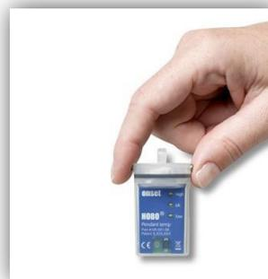
Thermographe utilisé pour le suivi de la température des rivières © AMIK
