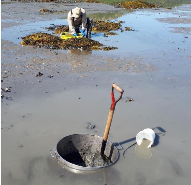
Station délimitée par un quadrant de métal de 0,25 m<sup>2</sup>, échantillonnée avec la technique conventionnelle à la pelle.
